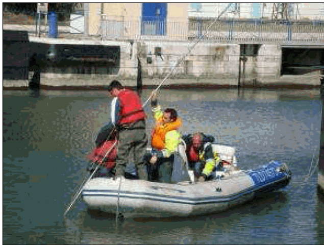
Figure 72 – Tube manuel pour prélèvement de sédiments fins.
