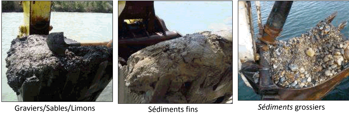
Figure 71 – Types de sédiments dragués sur le Rhône.
