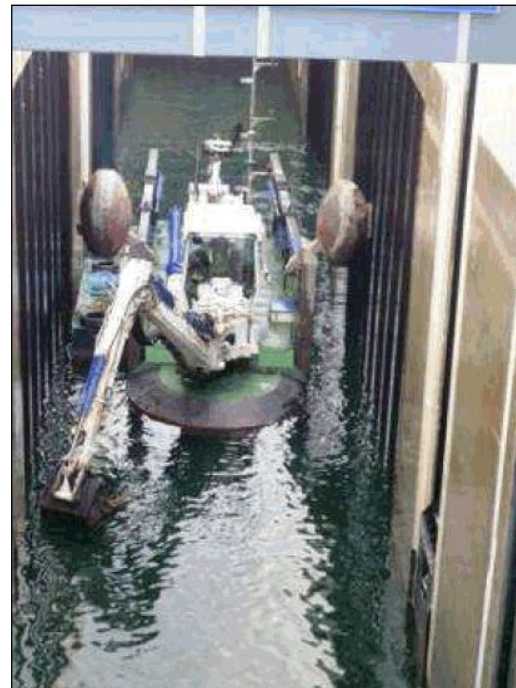
Figure 73 – Pelle amphibie pour zone peu profonde.
